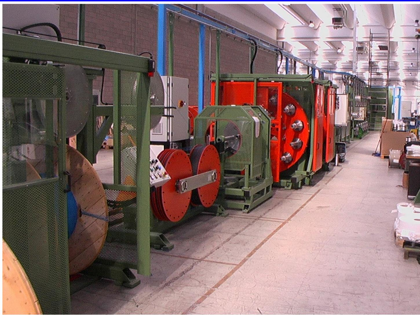
**Tipo de línea adecuada para el reunido con paso alterno S-Z, de cables de fibra óptica, formados por un tubo loose o fibra tight.**
